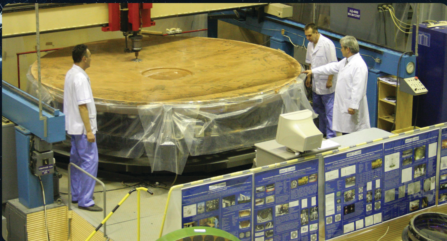
Финишная доводка зеркала диаметром 3.7м на станке АД-4000
