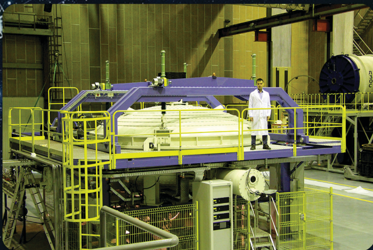
Вакуумная установка «Отражение» для нанесения оптических покрытий на зеркала диаметром до 4 метров.
