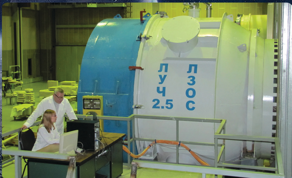
Установка ЛУЧ-2.5 для ионно-лучевой обработки крупногабаритных оптических деталей диаметром до 2.5м
