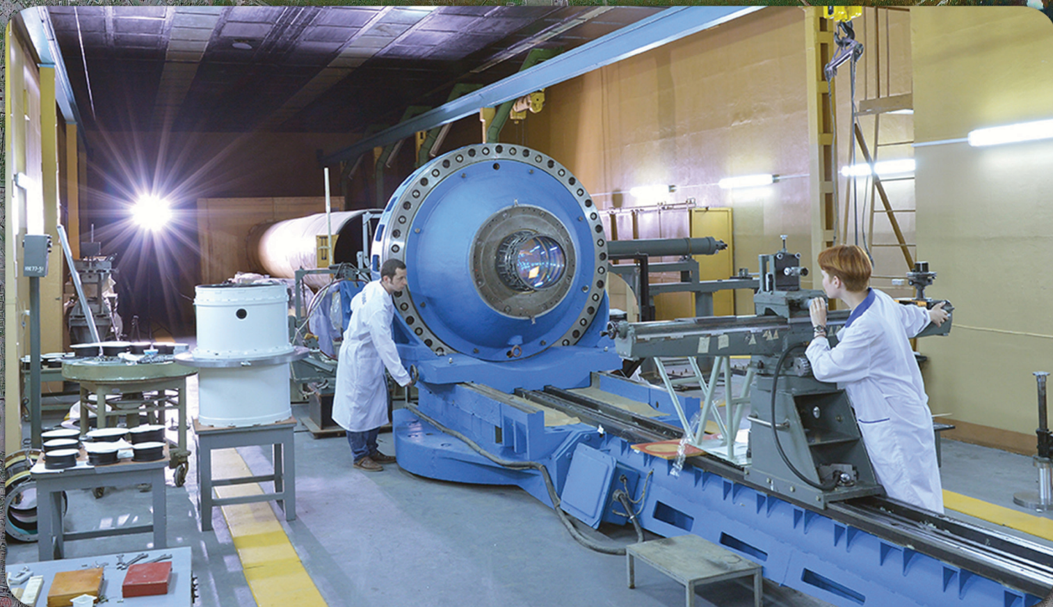
Оптическая скамья для юстировки и контроля оптических характеристик крупногабаритных линзовых объективов
