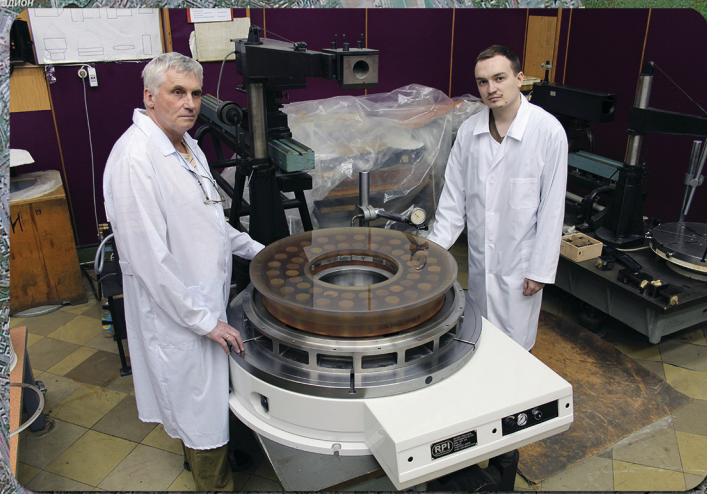
Сборка главного зеркала спецпаратуры «Сова»
