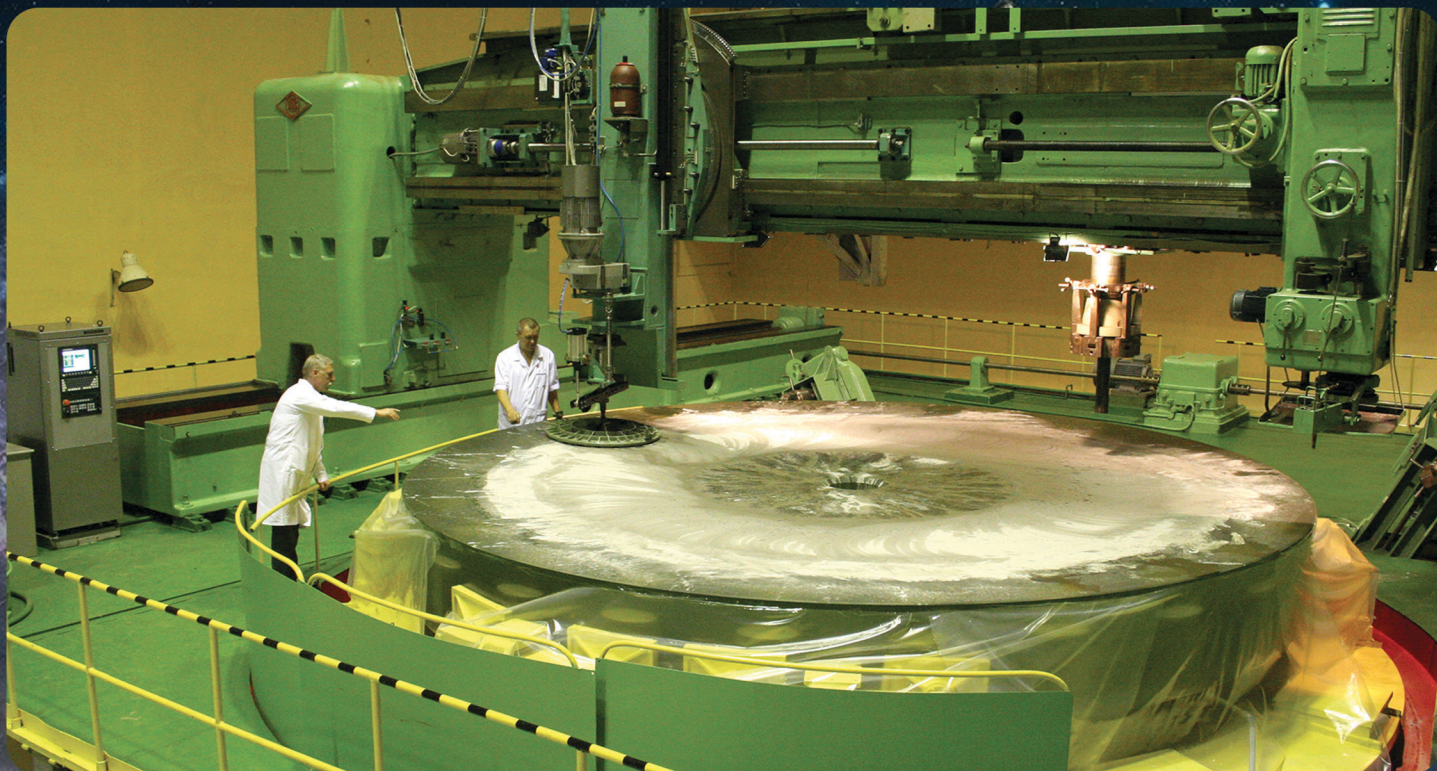
Процесс шлифовки зеркала диаметром 6 метров БТА на станке КУ-168АДМ.
