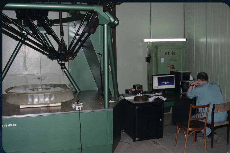
КИМ-1400 для измерений формы шлифованной поверхности с точностью 3-5 мкм.
