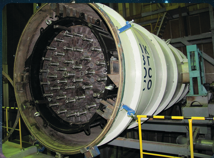
Вакуумный испытательный стенд для интерференционного контроля оптико-электронных систем.
