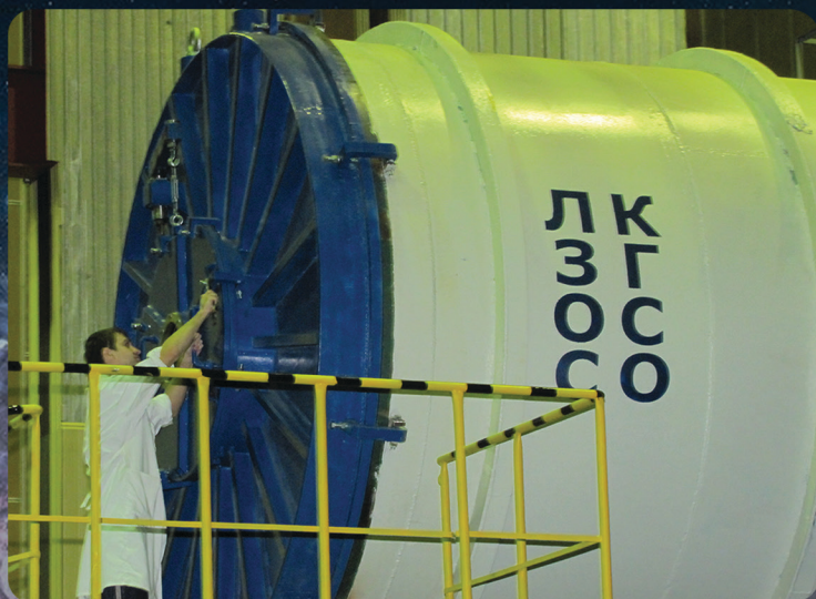
Вакуумный испытательный стенд для интерференционного контроля оптико-электронных систем.
