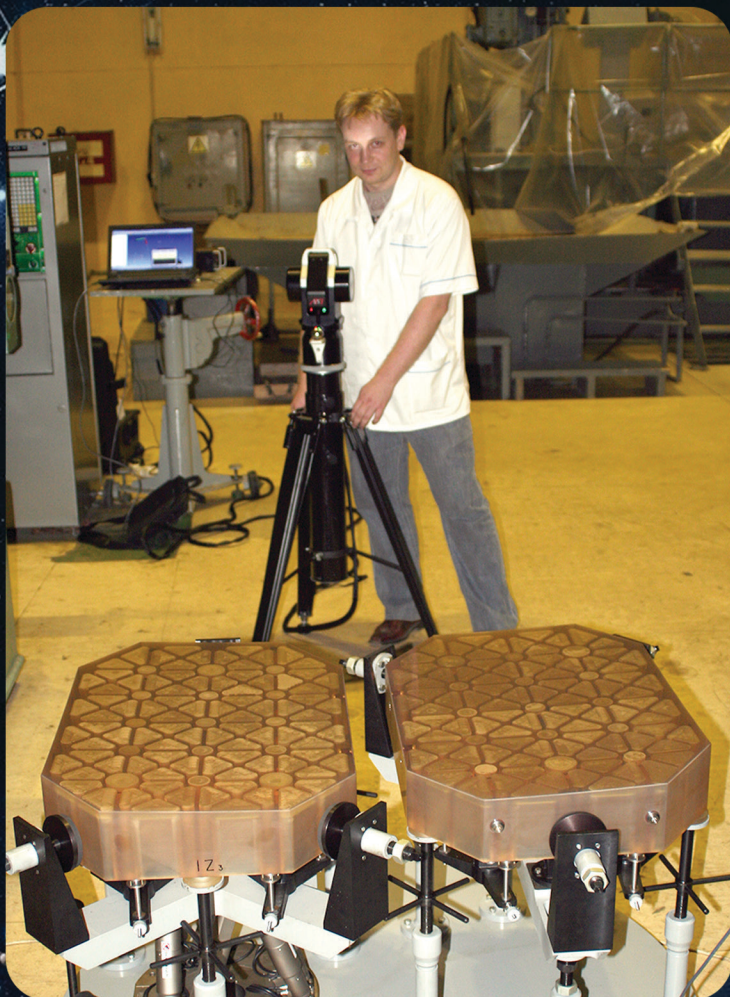
Зеркала объектива стереоаппарата космического базирования для дистанционного зондирования Земли.
