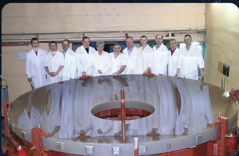
Главное зеркало диаметром 4 метра проект «VISTA»
