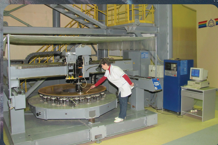
Финишное полирование рабочих поверхностей на станке АД-2000
