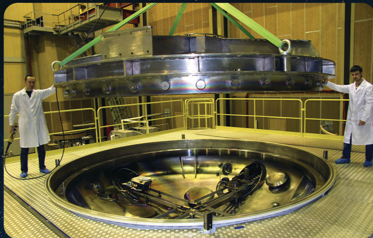
Вакуумная установка «Отражение» для нанесения оптических покрытий на зеркала диаметром до 4 метров.
